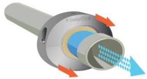
**5** Es importante asegurar que cuando se instale no haya claridades entre el Anillo y la tubería y que el Anillo no se mueva o gire alrededor de la tubería
